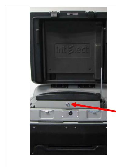
Using the Barrel key, lock the DS200 monitor in place
